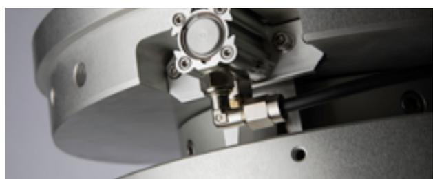
Der untere Ring ist mit pneumatischen Aktuatoren ausgestattet, die direkt vom Steuersystem gesteuert werden. Wenn der Mast ausgefahren ist, verriegeln sie automatisch die Sektionen; wenn der Mast geschlossen werden soll, können die Sektionen bei fehlender Luftzufuhr oder bei einem zu niedrigen Innendruck nicht entriegelt werden. Sobald beide Bedingungen erfüllt sind, kann der Schließvorgang in beiden Betriebsmodi, automatisch und manuell, sicher gestartet werden.
